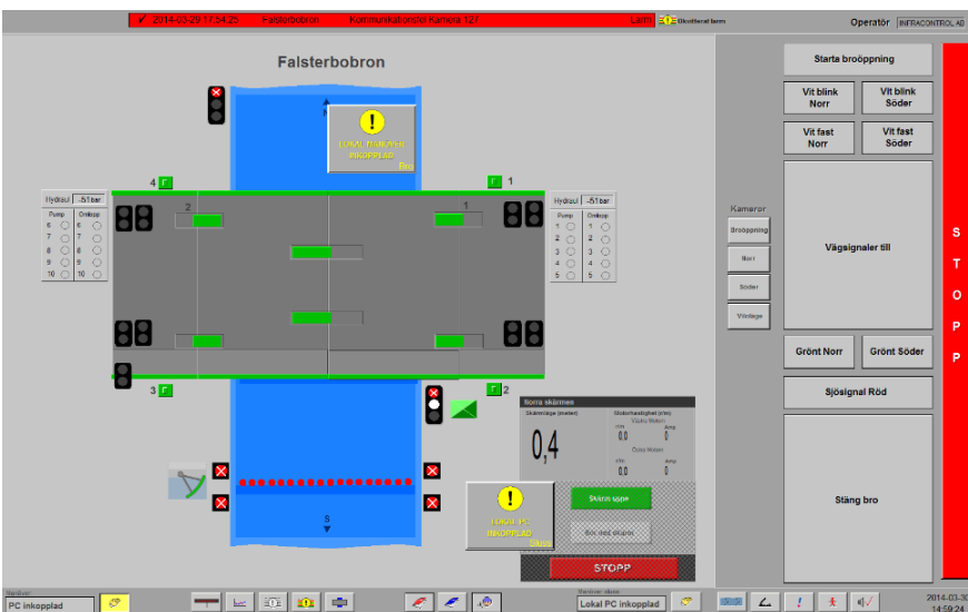
Användargränssnittet för manövrering av bro och sluss är baserat på en standard som togs fram av Sjöfartsverket och Infracontrol redan 1998.
