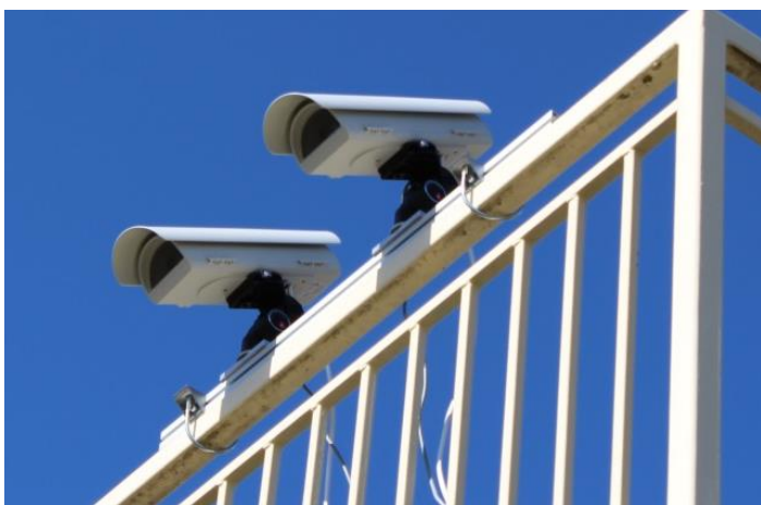
Viscandos system bygger på 3D-vision som skapas med dubbla standardkameror och en speciellt utvecklad analysprogramvara
